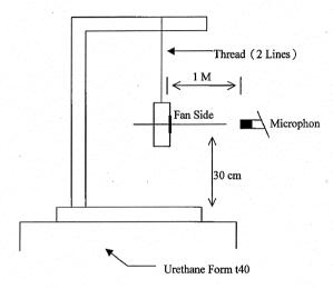
1 METER FROM MICROPHONE TO FAN INTAKE
