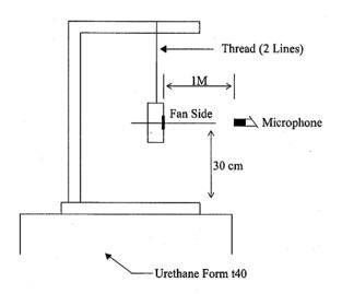
1 METER FROM MICROPHONE TO FAN INTAKE
