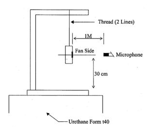
1 METER FROM MICROPHONE TO FAN INTAKE
