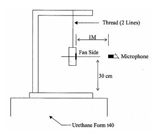
1 METER FROM MICROPHONE TO FAN INTAKE
